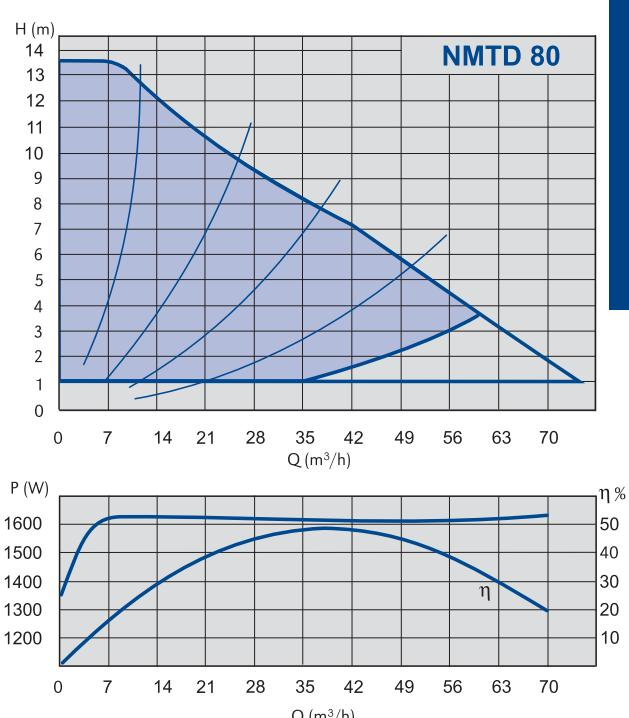
**Obtočne črpalke z motorjem s trajnimi magneti**
