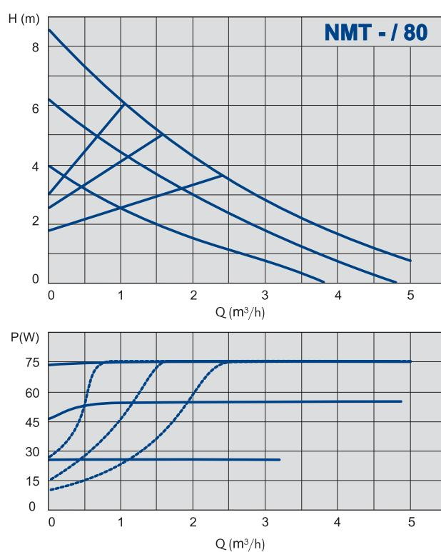
**Obtočne črpalke z motorjem s trajnimi magneti
