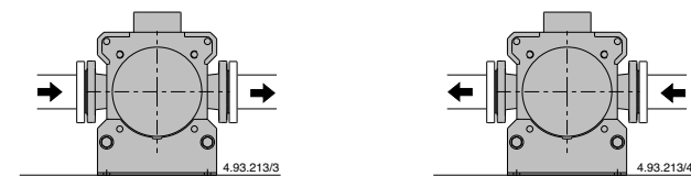
Вариант 1: всасывание слева, подача справа
