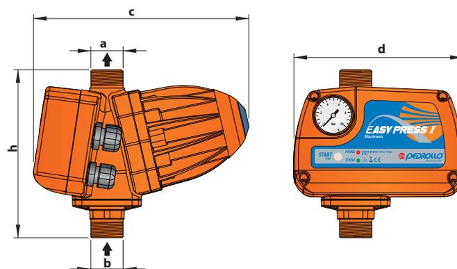
Специальное соединение из трех частей с уплотнением o-ring
